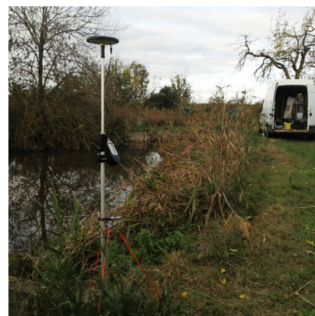
Rilievo batimetrico con gps differenziale
