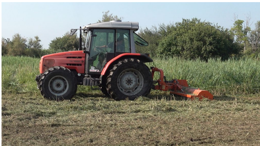
Eliminazione della vegetazione con trattore agricola montante una trinciatrice di tipo leggero
