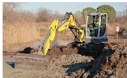
Scavatore medio da 80 q con braccio snodato
