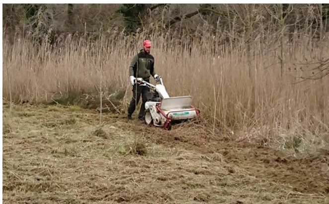
Lavorazione superficiale con trincia a conduzione manuale
